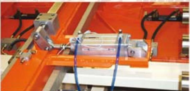
Le Groupe de Translation Automatique Horizontal a été conçu pour déplacer automatiquement les plateaux en acier avec carreaux frais et secs.
