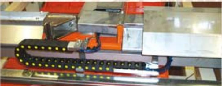
Устройство для горизонтального автоматизированного перемещения было проектировано для автоматизированного перемещения стальных подносов со свежими и выдержаными плитками.
