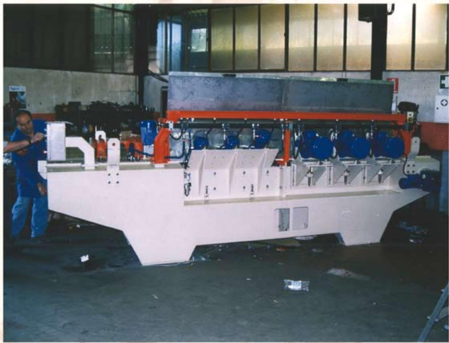
La Biseauteuse Désaccoupleuse Automatique mod. NBSX100 a été conçue et construite pour biseauter et désaccoupler les plinthes obtenues des carreaux en ciment et granito coupés en plusieurs bandes selon le format.
