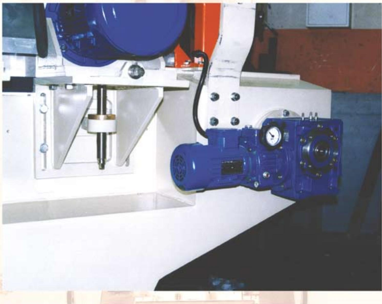
La Máquina Biseladora Explotadora Automática mod. RIBA NBSX100 ha sido diseñada para biselar y explotar cenefas recabadas de baldosas de cemento y granalla cortadas en más tiras según el formado. Se compone de un basamento construido de acero electrosoldado donde están ensamblados los componentes principales que constituyen la máquina en su complejidad:
