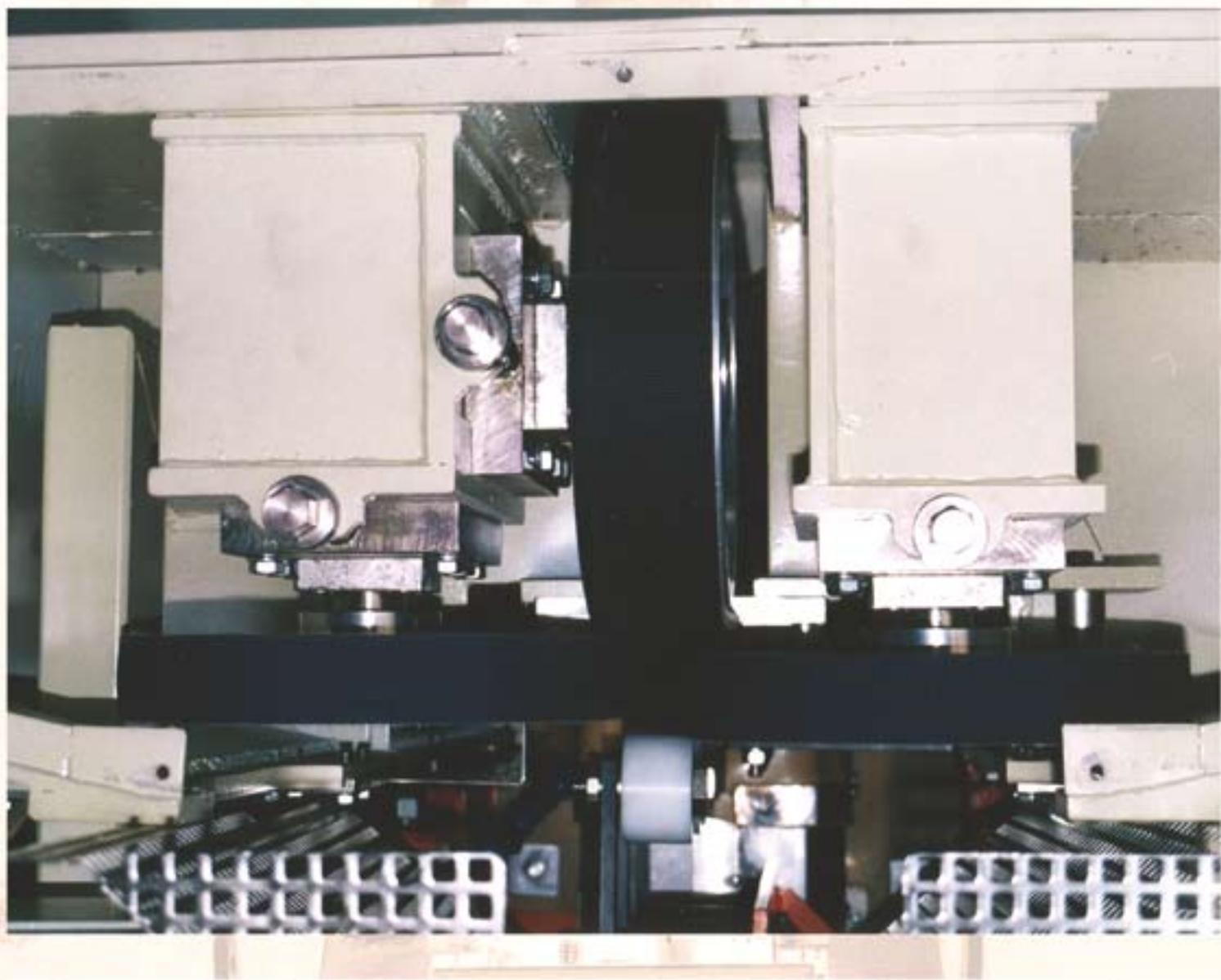
Станок для снятия фасок и раскалывательный станок мод. NBSX100 проектирован, чтобы снять фасок и раскалывать плинтуса от плиток из каменной крошки и цементных плиток, отрезанные на многих полосах в зависимости от формата.
