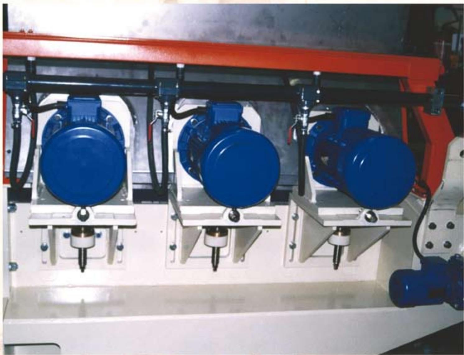
Die automatische Abschräg- und Spaltmaschine mod. RIBA NBSX100 wird zum Abschrägen und Spalten von Scheuerleisten eingesetzt, die je nach Format streifenförmig aus Zement- und Werksteinplatten geschnitten werden. Die Maschine besteht aus einer elektrogeschweißten Stahlkonstruktion, auf welcher alle Hauptbauteile der Maschine angebracht sind:
